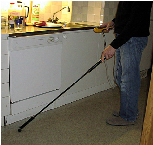
Bild 7.3 Läckande diskmaskiner kan ge upphov till fuktskador i golvet. Med hjälp av en fuktindikator som visas på bilden kan sådana skador identifieras.
