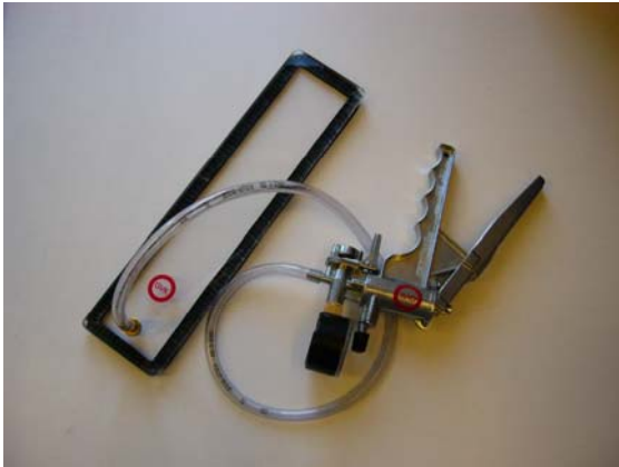
Bild 7.6 GVK-pumpen används för att kontrollera tätheten hos skarvar i tätskikt av plastmatta. Källa: GVK.
